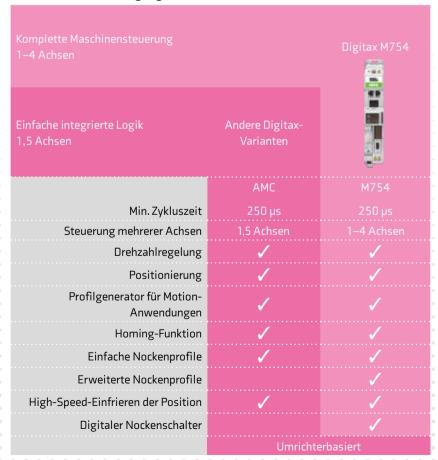
Der leistungsstarke MCi-Zweitprozessor im Digitax M754 erweitert die System- und Maschinensteuerungsmöglichkeiten des Umrichters, um Anwenderprogramme bis zu viermal schneller auszuführen als eine Standard-SPS.
