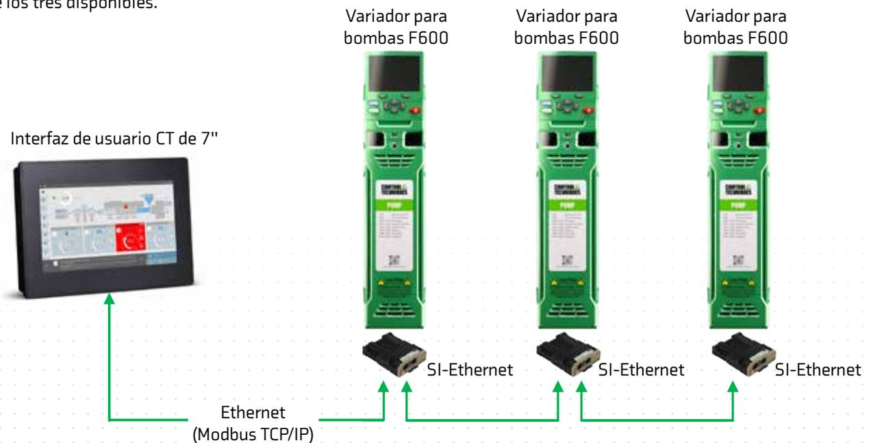
*Operación multilíder por Modbus TCP/IP*
