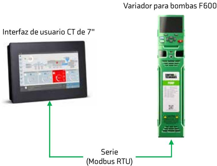
*Operación de bomba única por Modbus RTU*
