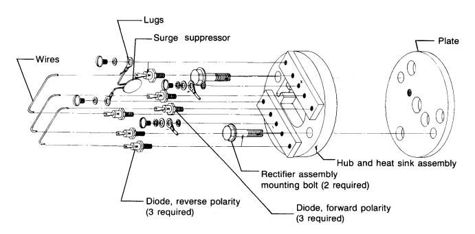
**Figure 3 Rotating Rectifier**
