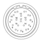
1 - Thermistor -10 - Cos + 2 - Thermistor + 11 - Data + 3 - Screen 12 - Data -4 - -13 - Cos -14 - Sin + 5 - -6 - -15 - Sin -16 - Power 17 - 0V 8 - Clock + 9 - Clock -Body - Screen
