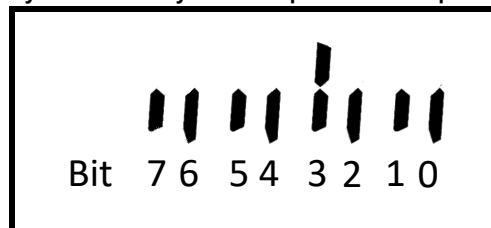
Rysunek 7-2 Wyświetlanie parametrów w postaci binarnej
