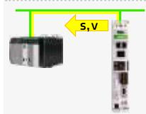
**Funzione Safe Value Transfer** permette il trasferimento del valore sicuro di velocità e posizione attraverso un bus di campo di sicurezza per un'ulteriore elaborazione del dato da parte del safety controller
