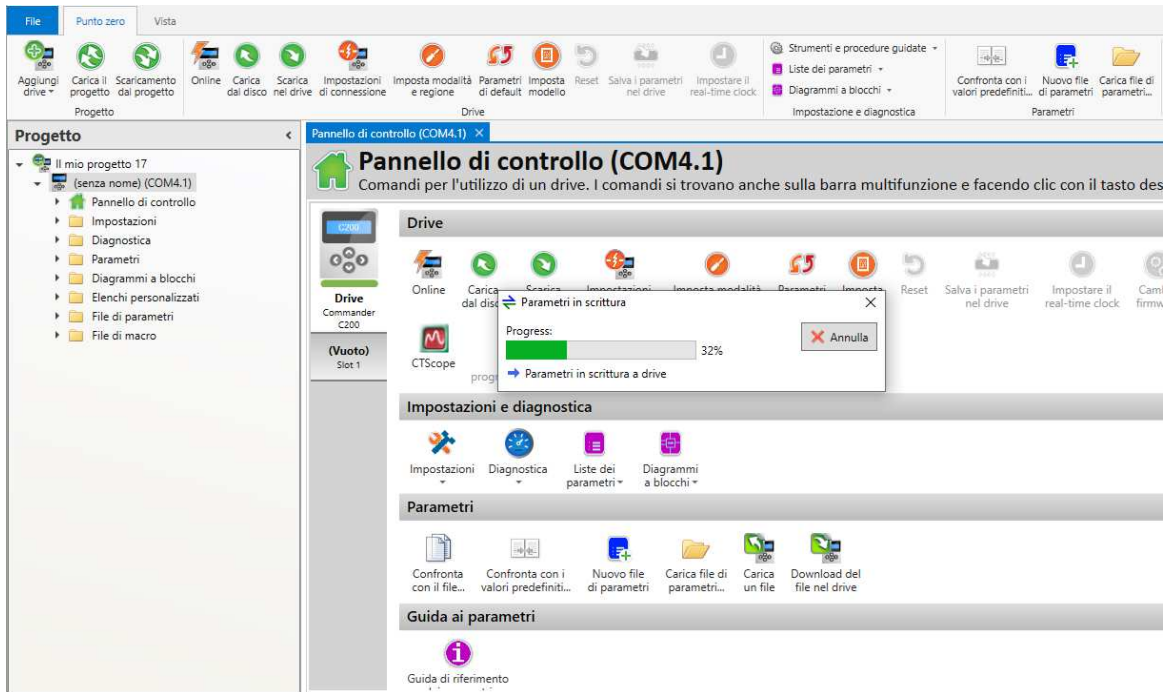
Figura 5.1 – Scrittura parametri nell’inverter in esecuzione
