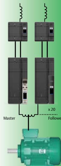
Il sistema modulare consente una configurazione del drive fino a 2,8 MW
