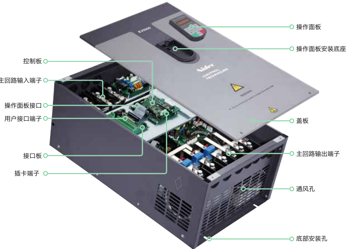
30kW及其功率等级以上变频器结构图
