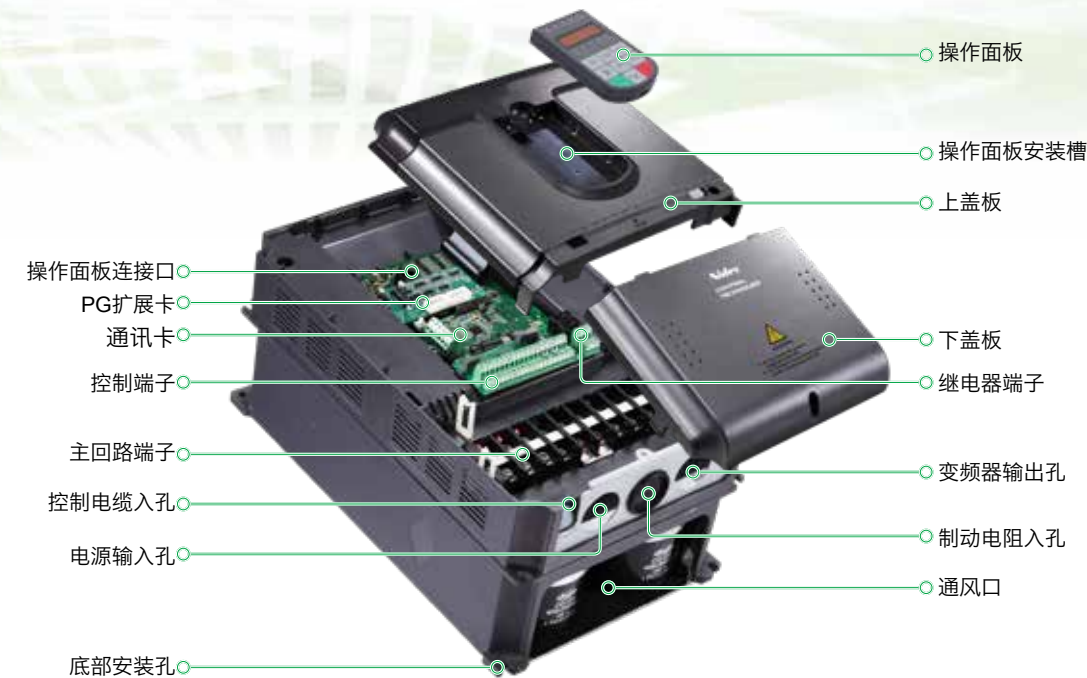
30kW及其功率等级以上变频器结构图
