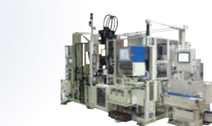
Crank Shaft Automatic Measuring Machines 直列4気筒クランクシャフト計測刻印機
